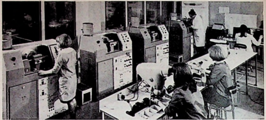
Stofvrije ruimte voor het spiralisieren van metaalfilmweerstand.
