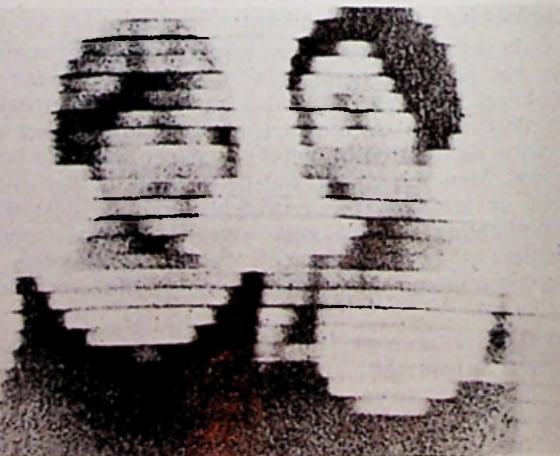
Een in de 30-er jaren met de Nipkowschijf verkregen TV-beeld. (Foto AEG - Telefunken)
