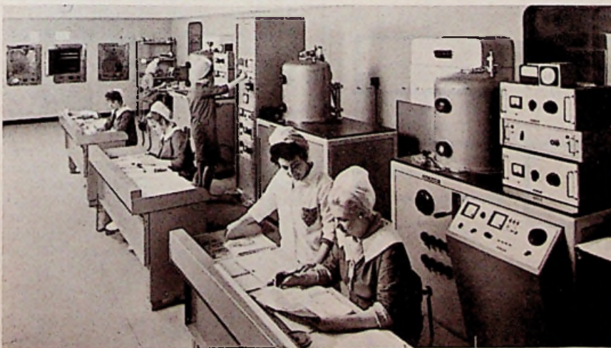
Stofvrije ruimte voor het opdampen van metaalfilmweerstand (foto's Morganite)
